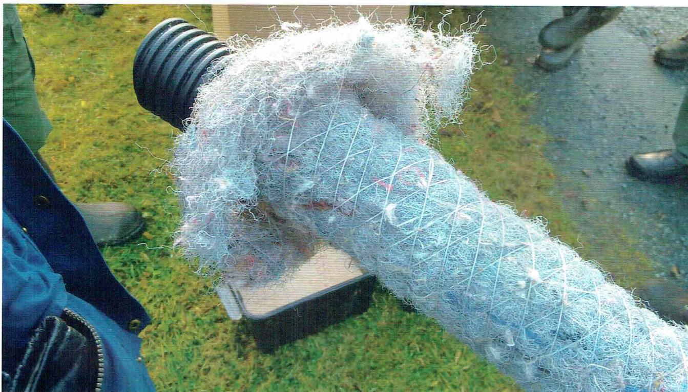
Tepperør med indre diameter på 60 mm. Nålefilten er vevd rundt røret og holdes på plass av en nettingstrømpe.
